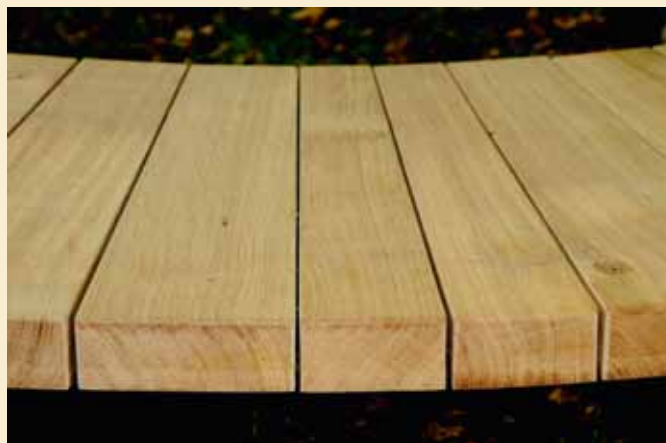
Spejlskæringen af flådeegene ses som lange lyse striber i veddet – og årringe der står vinkelret på skærefladen.
