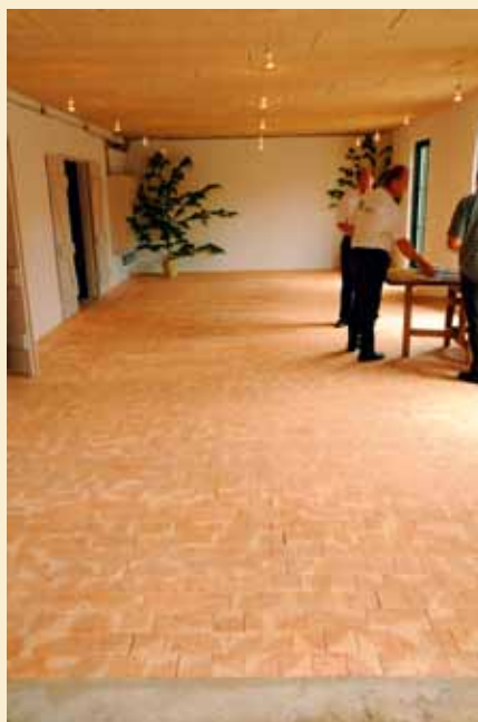
Bænkene præsenteres i et nyt showroom på Bondeskovgård ved Osted. Gulvet er lavet af endetræ af douglasgran skåret i stykker på 10x10x10 cm.
